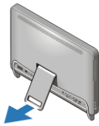
Figure 3. Installation du socle inclinable arrière
